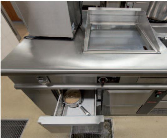
Herzstück der Eden-Küche ist die massgeschneiderte multifunktionale Premium Induktionsherdanlage der Menu System AG mit flächendeckenden Vierer-Induktionskochfeldern, zwei Dreier-Induktionskochfeldern mit Slide Control, mit beidseitig bedienbarem Hartchrom-Grill, Bain-Marie, Mischbatterie, Mixer-Halterung sowie mit Kühl-, Wärme- und Cook& Hold-Schubladen im Unterbau.
